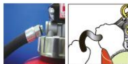
× 緊結ネジの破損 × ホースの脱落
