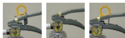
× 安全栓の抜けかけ × 安全栓の脱落 × レバー支えの脱落
