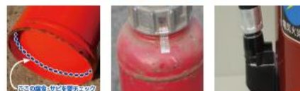
× 底部の腐食 × 著しい腐食 × 消火薬剤の漏れ
